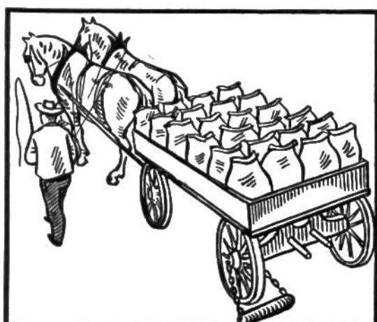
Beim Aufwärtsziehen von Lasten soll häufig angehalten und verschnauft werden. Das nachherige Anfahren wird durch Unterlegen eines Bremskeils hinter ein Hinterrad erleichtert. Ein angehängtes „Tröhlholz“ tut den gleichen Dienst.
