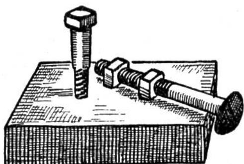
Wenn man keinen Schraubenschlüssel zur Hand hat, schraubt man zwei Muttern in eine Schraube. Die andere Mutter, die man anziehen muss, kann man zwischen die beiden Muttern klemmen; sie lässt sich nun gut drehen.
