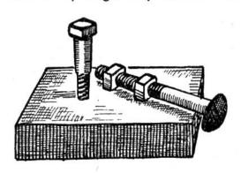
Wenn man keinen Schraubenschlüssel zur Hand hat, schraubt man zwei Muttern in eine Schraube. Die andere Mutter, die man anziehen muss, kann man zwischen die beiden Muttern klemmen; sie lässt sich nun gut drehen.
