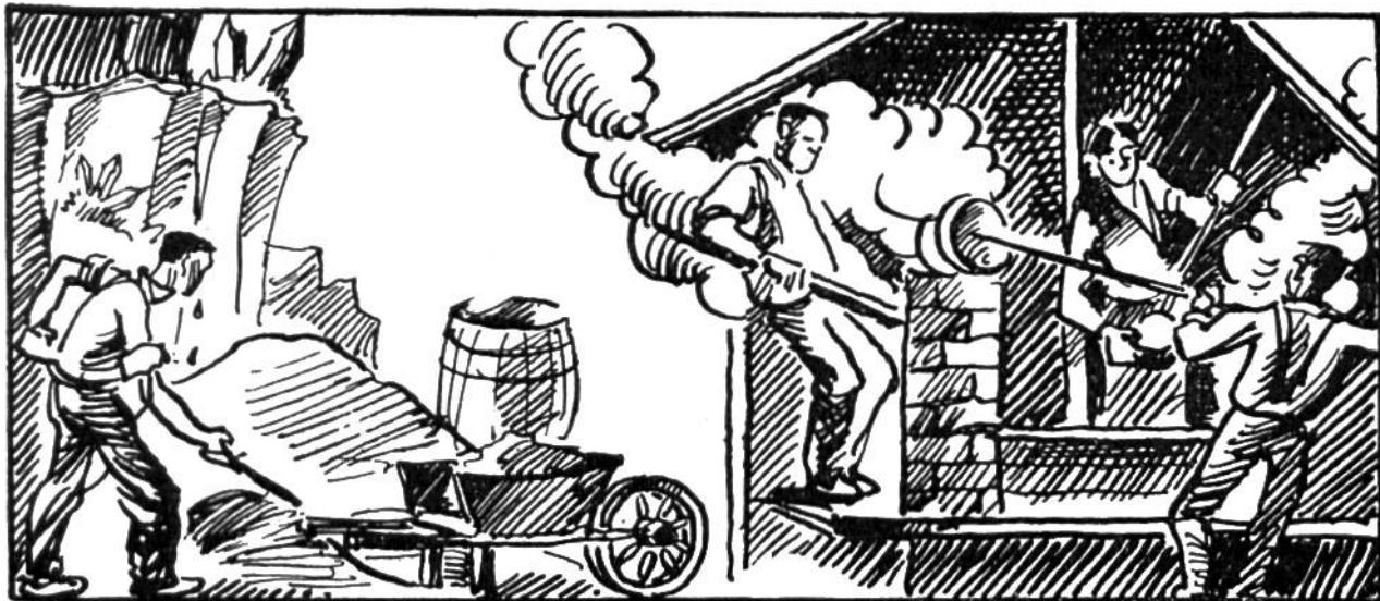
**Glas** wird durch Zusammenschmelzen von Kieselsäure (Sand, Feuerstein, Bergkristall) mit Pottasche oder Soda hergestellt. Diese Materialien werden zu einem dünnflüssigen Gemisch eingeschmolzen. Die Masse wird abgekühlt, denn ihre weitere Verarbeitung ist nur bei Zähflüssigkeit möglich. Das Formen der Glasmasse geschieht durch Blasen und Pressen, bei billiger Gebrauchsware auch mittels Hohlformen. Das Glasblasen geschieht jetzt meist durch Maschinen. Die Glasmacherkunst ist etwa 4000 Jahre alt.
