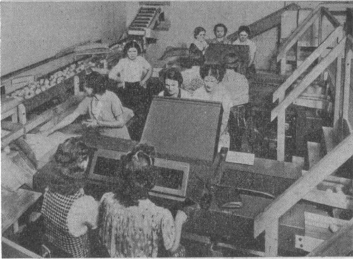
Röntgenstrahlen im Dienste der Lebensmittelprüfung. Kalifornische Orangen werden vor der Verarbeitung auf dem Laufband durchleuchtet und nicht einwandfreie Früchte ausgeschieden.
