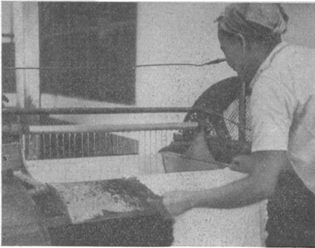
Maschinelle Herstellung der Crêpe-Kautschukfelle.
