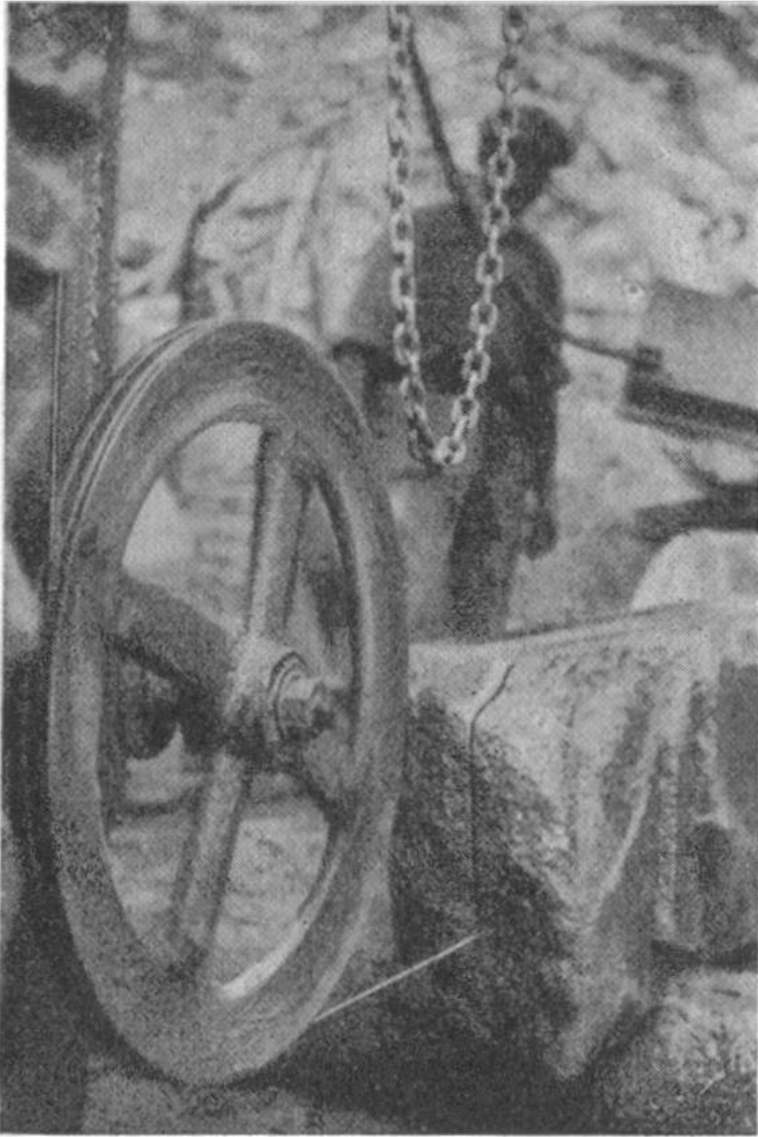
Die Stahldrahtsäge frisst sich in der Stunde etwa 10 cm tief durch den Marmor.
