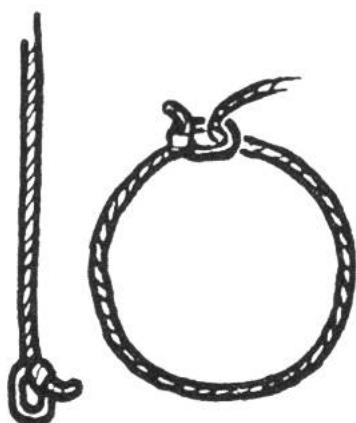
**Verbesserte Seilschlinge.** Nach Mitteilung von Regina Horn, 13 Jahre, Zofingen. Beim Binden gleitet das Seil oft schwer durch gewöhnliche Schlingen; zudem wird das Seil bei zu starkem Ziehen leicht beschädigt. Durch Anbinden eines Kettengliedes am einen Ende des Seils kann man den Strick schonend und leicht hindurchziehen.
