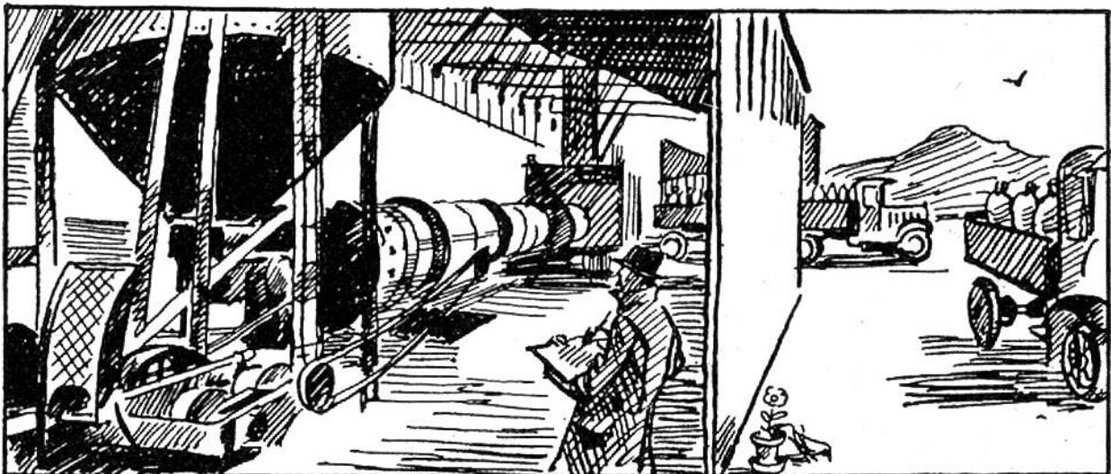
**Zement** nennt man Bindemittel, die mit Wasser gemengt nicht nur an der Luft, sondern auch unter Wasser erhärten. Der bekannte Portlandzement besteht aus Kalk und tonhaltigen Stoffen, die gemahlen, miteinander vermischt und dann in langen, sich drehenden Röhrenöfen bis zum beginnenden Schmelzen gebrannt werden. Der gebrannte Zement wird gebrochen und darauf zu feinstem Pulver zermahlen.
