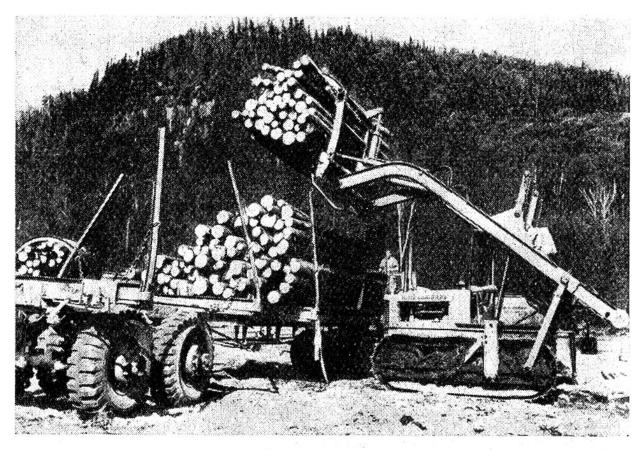
Eine amerikanische Säge- und Lademaschine beim Verladen des Holzes.
