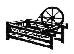
1764 baute James Hargreaves, ein armer englischer Weber, nach mühseligen Versuchen die erste brauchbare Spinnmaschine, die gleichzeitig 8 Fäden spann. Er nannte sie nach seiner Tochter "Jenny-Maschine". Arbeiter, die durch die neue Ma-
