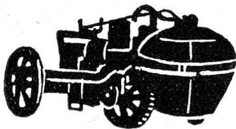
**1769** fuhr der erste Dampfmotorwagen, ein Vorläufer der Lokomotiven und Automobile. Der Franzose Cugnot hatte ihn im Auftrag der franz. Regierung für den Transport schwerer Geschütze gebaut; es war ein schweres, dreiräderiges
