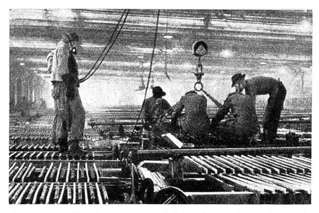
Der grosse Tankraum zur elektrolytischen Abscheidung von Zink. Das Metall scheidet sich an den als Kathoden (negativer Pol) eingehängten Aluminiumblechen in Plattenform ab. Die Anoden (positiver Pol) sind Bleiplatten, auf denen sich Verunreinigungen ausscheiden und die öfters gehoben und gereinigt werden müssen. Zum Schutz gegen die ätzenden Bäder und deren Dämpfe tragen die Arbeiter Gasmaske, Gummihandschuhe und-Stiefel.
