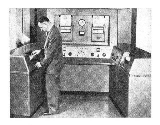
Ein Faksimile-Sender mit zwei Trommelapparaten für die pausenlose Übertragung von Schrift,Druck und Bildern.
