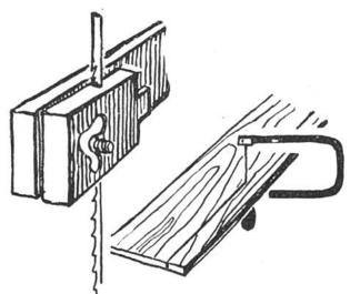
den abnehmbaren Halter ab und feilt auf dessen Innenseite eine Kerbe. Man muss aber aufpassen, dass diese nicht zu tief wird, sonst würde das quer eingespannte Sägeblatt ausrutschen. Nach dem Einspannen des Sägleins wird die Schraube fest angezogen, und man kann drauflossägen, ohne dass der Laubsägebogen hinderlich ist.
