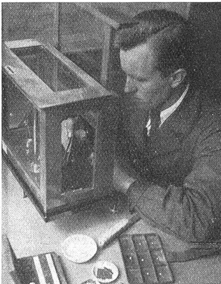
Auf der Goldwaage werden Legierungen eingewogen, die zur „Feuerprobe“ in den Schmelzofen kommen. Zum Schutze vor Witterungseinflüssen steht d. Waage in einem Glaskasten.
