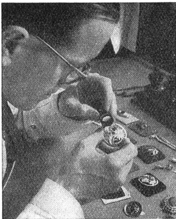
Marken und Bezeichnungen, die auf den Edelmetallwaren eingeschlagen sind, werden vermittelst der Lupe geprüft.
