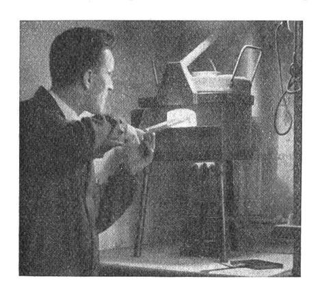
Im Probierofen wird eine Legierung bei hoher Temperaturin Knochenasche-Tiegelneingeschmolzen
