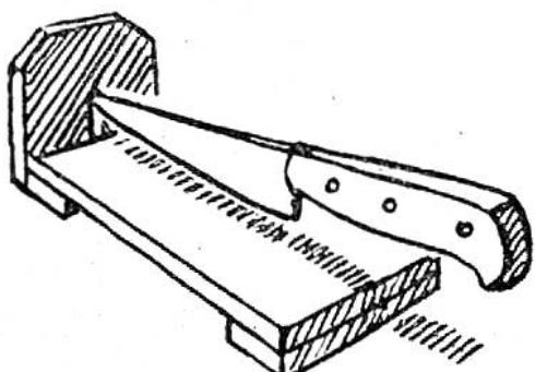
**Ein praktischer Quittenschneider.** Nach Mitteilung von Bruno Stauffer, 12 Jahre, Hinteregg. Ein Brettchen von ca. 22 cm Länge und 12 cm Breite wird mit zwei Querleisten verstärkt. In ein zweites, 12 cm langes Brettchen wird ein Schlitz gesägt, so dass ein grosses Küchenmesser mit der Spitze hineinpasst. Die beiden Brettchen werden rechtwinklig zusammengenagelt. Der Quittenschneider ist fertig
