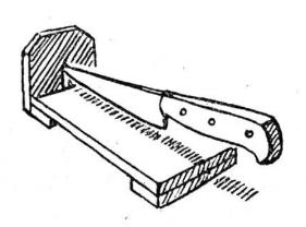
Ein praktischer Quittenschneider. Nach Mitteilung von Bruno Stauffer, 12 Jahre, Hinteregg. Ein Brettchen von ca. 22 cm Länge und 12 cm Breite wird mit zwei Querleisten verstärkt. In ein zweites, 12 cm langes Brettchen wird ein Schlitz gesägt, so dass ein grosses Küchenmesser mit der
