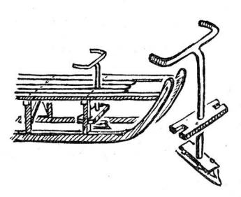
Schlitten. Nach Mitteilung v. Hans Schenkel, 14 Jahre, Benken. Wir nageln ein Brettchen, das in der Mitte ein Loch hat, unten zwischen die beiden vordern Stützen des Schlittens. Dann stecken wir einen Stab mit einer Lenkstange durch das Loch des Brettchens und befestigen unten einen Schlittschuh daran.
