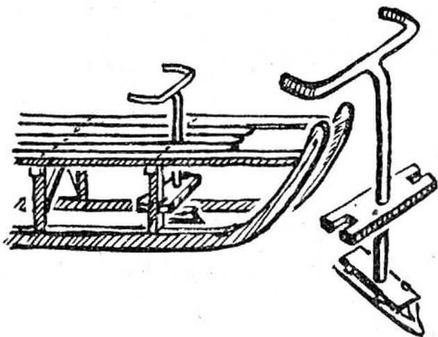
**Eine Lenkstange am Schlitten.** Nach Mitteilung v. Hans Schenkel, 14 Jahre, Benken. Wir nageln ein Brettchen, das in der Mitte ein Loch hat, unten zwischen die beiden vordern Stützen des Schlittens. Dann stecken wir einen Stab mit einer Lenkstange durch das Loch des Brettschens und befestigen unten einen Schlittschuh daran.
