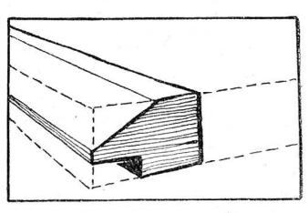
Querschnitt des Rahmenholzes mit einfachem Profil.
