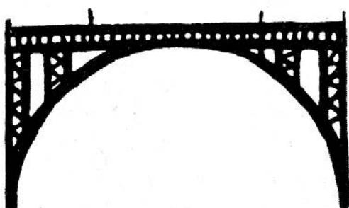
**1779** wurde die erste eiserne Brücke der Welt über den Severn bei Coalbrookdale in England gebaut. Die älteste eiserne Brücke auf dem Festland führt über das Striegauer Wasser in Deutschland (1794—96 erbaut). Beides sind gusseiserne Bogenbrücken und bestehen heute noch. Nach der Erfindung des Walzprozesses im Jahre 1820 trat an Stelle des Gusseisens das Schmiedeisen, das den Bau von weitgespannten Balken- und Hängebrücken ermöglichte.
