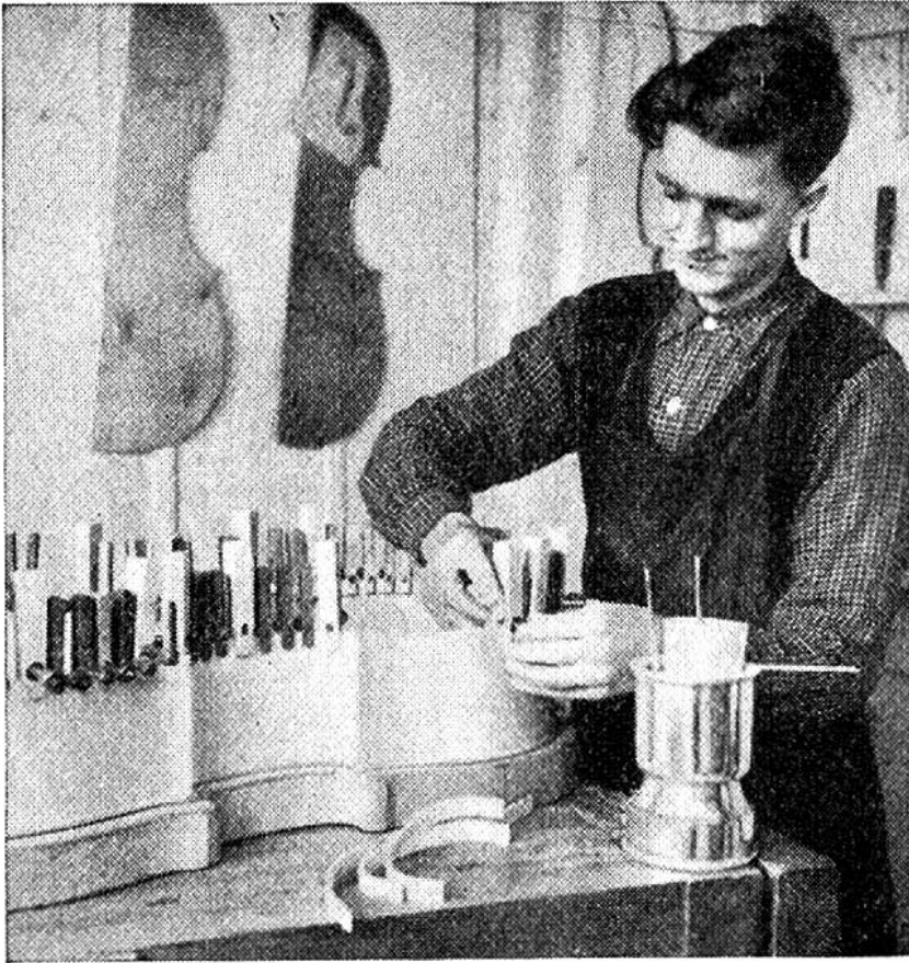
Bau eines Cellos: der Schüler leimt die „Bereifungen“ in den Zargenkranz.
