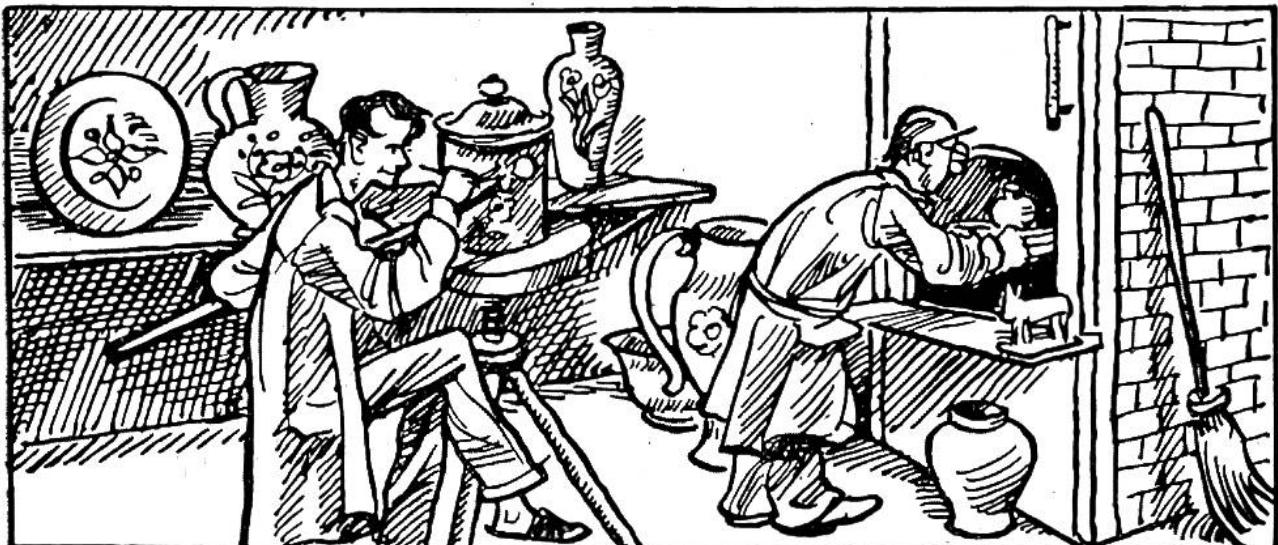
**Glasur und Email** sind glasartige Massen, die durch Aufschmelzen auf Ton- und Metallwaren angebracht werden. Sie bestehen wie Glas aus Kieselsäure, enthalten aber je nach ihrem Zweck die verschiedensten Zusätze (Erden, Metalle, Salze). Oft wird der Glasur- oder Emailbrei gefärbt. Häufig kommen auch Verzierungen oder Malereien unter oder über die Glasur- oder Emailschicht.
