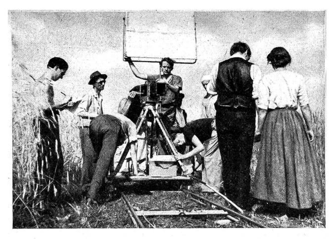
Aussenaufnahme, Die Bildkamera ist auf einem Fahrgestell angebracht, damit sie dem Dahinschreiten der Schauspieler ständig folgen kann. Mit der hellen Fläche (der sog. "Silberblende") über dem Kameramann wird das Sonnenlicht reflektiert, um die Schatten aufzuhellen. Die Tonaufnahme zu Szenen im Freien erfolgt meist später im Studio.
