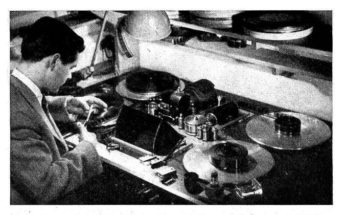
Arbeit am Schneidetisch. Hier erhält der Film seine endgültige Form. Über die beiden Spulen links und rechts hinten auf dem Tisch läuft der Bildstreifen. Der "Cutter" (Schnittmeister) kann ihn auf der abgeschirmten Glasscheibe vorn in der Mitte vergrössert sehen. Der Tonstreifen, der über die beiden vordern Spulen läuft, wird synchron angelegt, d. h. Bild und Ton werden auf Gleichlauf gebracht.
