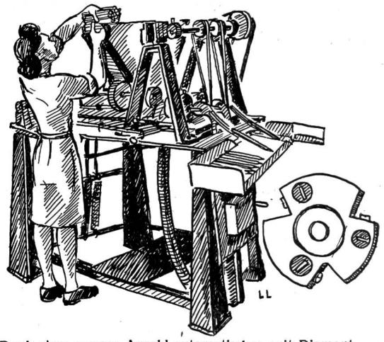
Dank einer grossen Anzahl automatischer, mit Diamantfräsen versehenen Spitzmaschinen, die mit 12000 Umdrehungen in der Minute arbeiten, liefert CARAN D'ACHE, als einzige Bleistiftfabrik der Welt, alle Bleistifte gespitzt.
