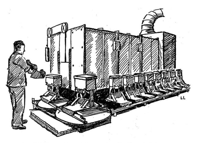
Im elektrischen Tunnelofen werden die Minen bei einer regelmässigen Temperatur von 1200° gleichmässig gebrannt.
