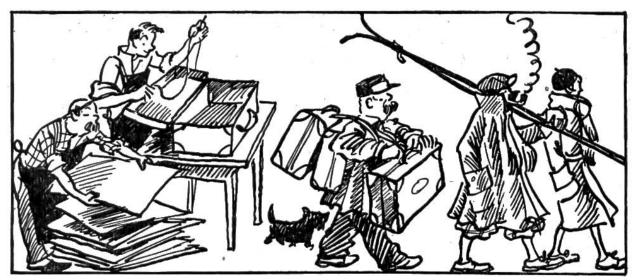
Fiber (Vulkanfiber) ist ein Kunststoff, der dem Hartgummi ähnlich ist. Grauer, roter oder brauner Karton wird mit einer chemischen Lösung (Chlorzinklösung) behandelt, zu beliebig dicken Platten zusammengepresst und getrocknet. Vulkanfiber wird häufig zur Herstellung von Koffern verwendet und ist auch zu Isolierungen brauchbar.
