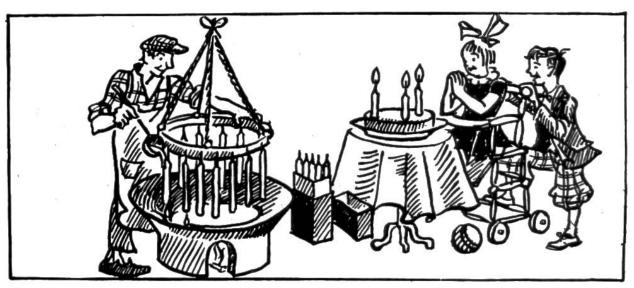
**Stearin.** Zersetzt man den "Seifenkern" mittels Säuren, so kann aus dem erhaltenen Gemenge von fetten Säuren durch Pressen Stearin gewonnen werden. Stearin wird hauptsächlich zu Kerzen verarbeitet.
