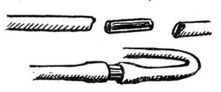
passt. Die beiden Schlauchstücke schiebt man so weit über das Eisenrohr, bis sie sich berühren. Der so geflickte Gartenschlauch ist wieder gut zu gebrauchen.
