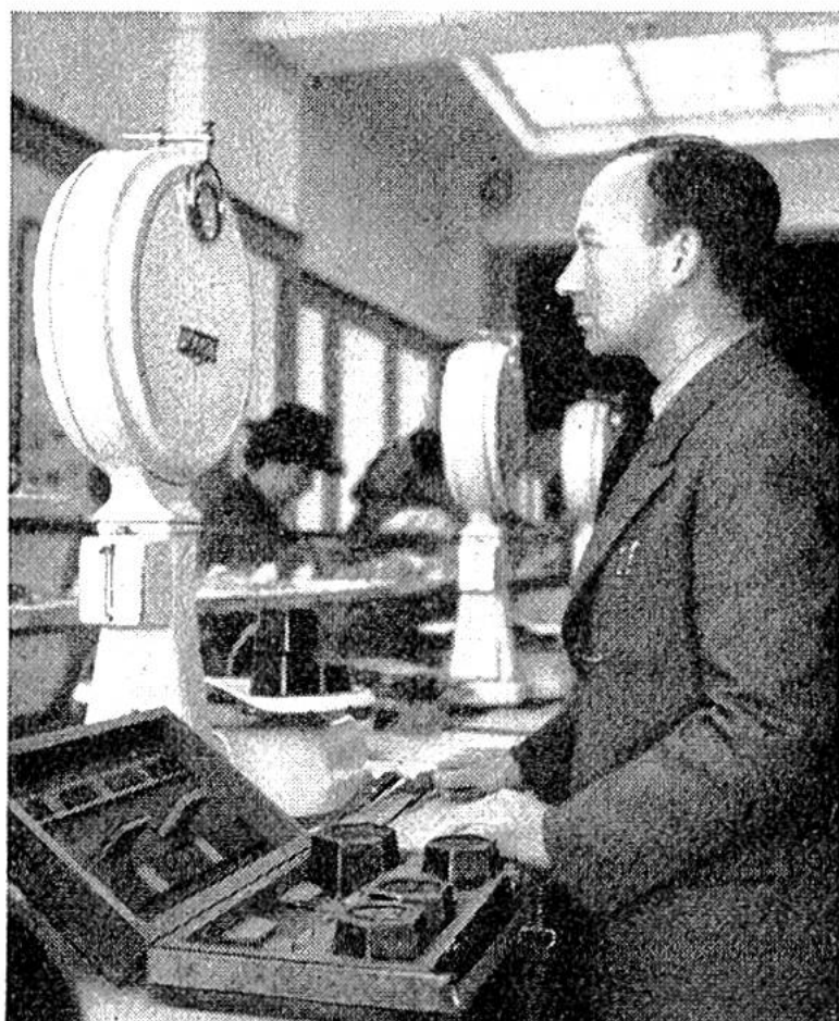
Nachkontrolle im Verkaufsladen. Der Eichmeister kann die automatischen Waagen unter Verwendung der mitgebrachten Normale auf das Milligramm genau prüfen.
