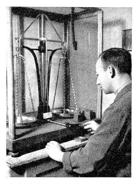
Mit der Prüfwaage kontrolliert der Eichmeister die aufgelegten Gewichtssteine auf ein Milligramm genau. Auf der linken Waagschale liegt der zu prüfende Stein, auf der rechten das Einheitsmass (Normal).
