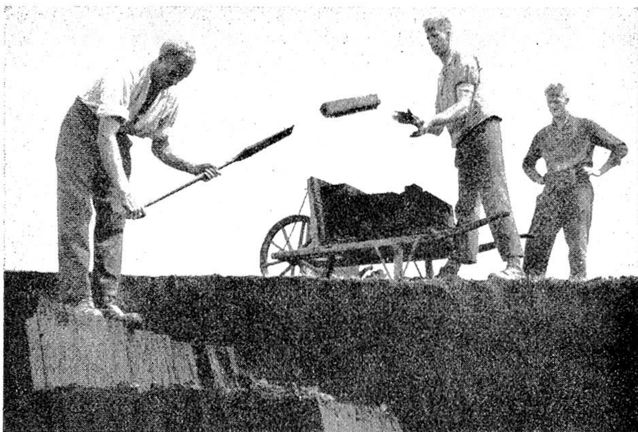
Abbau von Hand nach altgewohnter Art. Der Torf wird lagenweise mit einem besonders geformten Spaten abgestochen.
