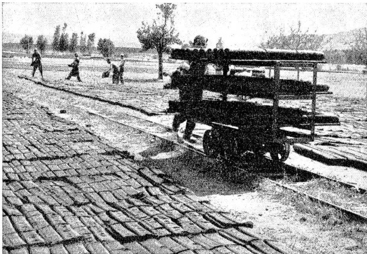
Der Maschinentorf wird auf Rollwagen zum grossen Trocknungsplatz gefahren und ausgelegt. Je nach der Witterung benötigt der Torf 2—10 Wochen zum Trocknen.
