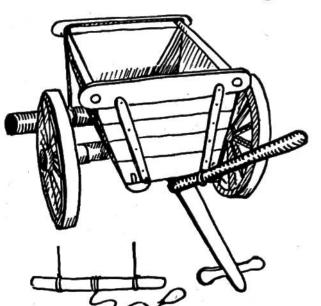
wir den Strick am Ende eines Reitels (Knebel) befestigen, <sup>1</sup>/<sub>3</sub> soll gegen die Deichsel, die andern <sup>2</sup>/<sub>3</sub> gegen aussen schauen. So kann durch Drücken des Reitels nach hinten eine grosse Last sicher gebremst werden.
