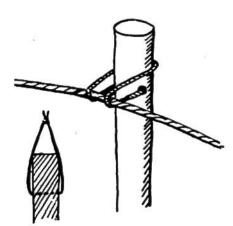
zusammengeknüpft, dass sie noch etwa 5 cm über die Stange hinausragt. Die Schnur wird nun um das gespannte Wäscheseil herumgenommen und dann über das Stützenende gestülpt. Beim Aufrichten der Stütze trägt die Schnur das Wäscheseil. Der Wind ist machtlos geworden, die Stütze kann nicht mehr umfallen!
