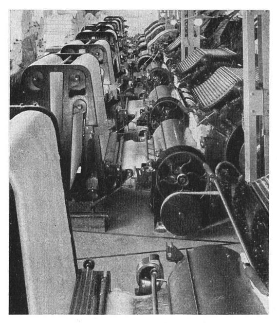
Kardiermaschinen. Hier entsteht die fertige Watte.
