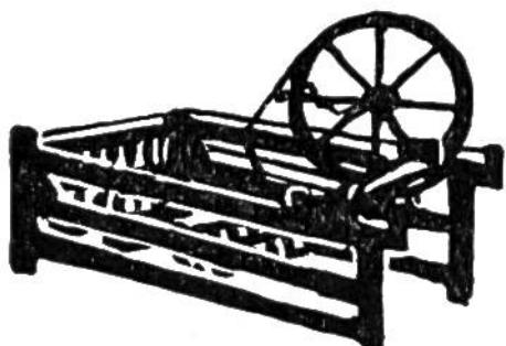
**1764** baute James Hargreaves, ein armer englischer Weber, nach mühseligen Versuchen die erste brauchbare Spinnmaschine, die gleichzeitig 8 Fäden spann. Er nannte sie nach seiner Tochter „Jenny-Maschine“.
