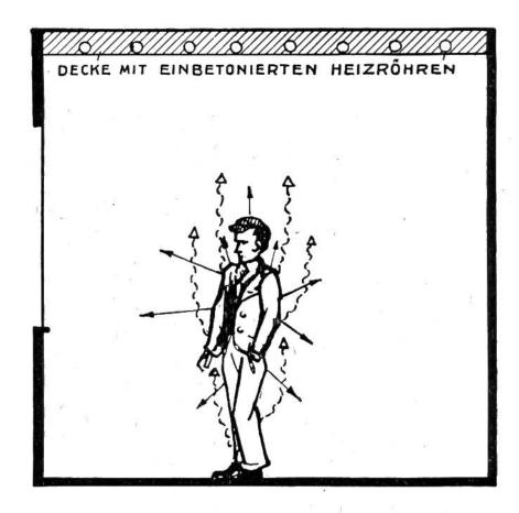
Wärmeabgabe des Menschen in einem Raum mit Strahlungsheizung: Mehr Abgabe an die Luft (Konvektion, dargestellt durch:
