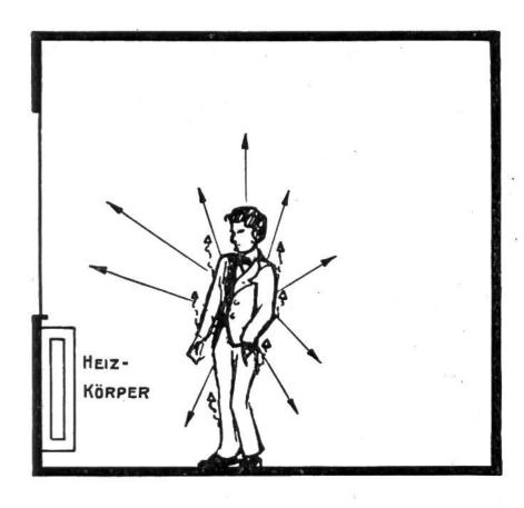
Wärmeabgabe des Menschen in einem Raum mit gewöhnlicher Zentralheizung: Mehr Abgabe an Wände, Boden, Möbel usw. (Strahlung, dargestellt durch:
