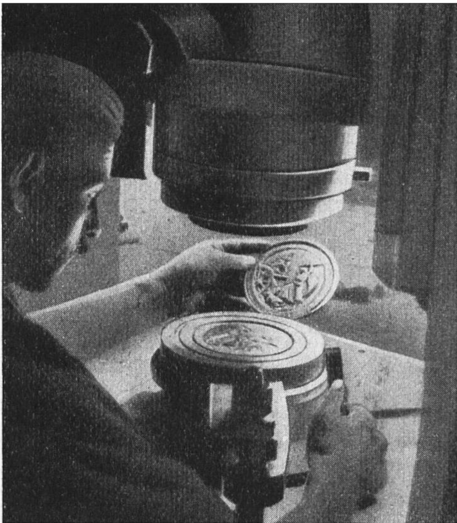
Moderne elektrische Präg- presse. Vorder- u. Rückseite der Medaille wer- den mit einem Schlag geprägt.
