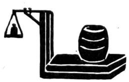
1822 erfand der Strassburger Mechaniker Quintenz die Dezimaloder Brückenwaage. Infolge eines fein durchdachten Hebelsystems war das Auflegen des Gegengewichtes bedeutend vereinfacht worden. Das Gewicht der Last, die auf eine
