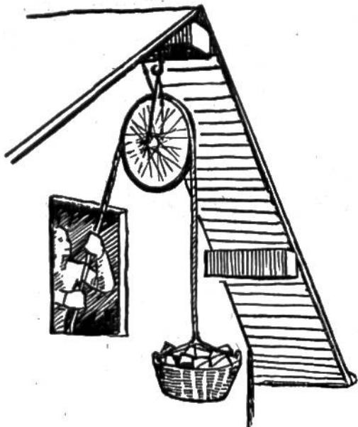
**Aufzug für Kleinholz, Garben oder Reisigbündel.** Nach Mitteilung von Jakob Knellwolf, 14 Jahre, Gachnang. An Stelle des gebräuchlichen Seilaufzuges mit Rolle, lässt sich auch ein altes Velorad ohne Pneu verwenden. Mit einem starken Eisendraht wird das Rad an der Achse aufgehängt. Das Seil hat in der tiefen Rille des Rades eine gute Führung und infolge des Kugellagers ist die Reibung gering.
