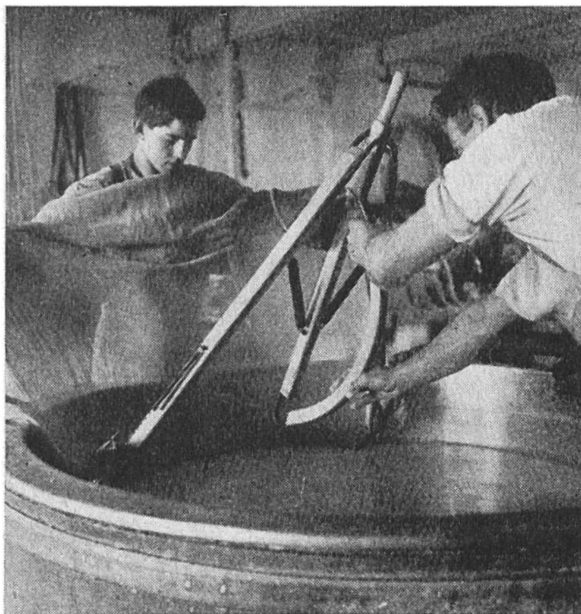
7. Das „Ausrühren“ ist zu Ende. Die rohe Käsemasse hat sich „gesetzt“. Der Käser erfasst sie mit einem gespannten Käsetuch.
