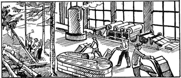
Zellstoff ist ein aus Holz gewonnenes Produkt. Kocht man zu kleinen Stücken zerhacktes Holz einige Stunden in Natronlauge unter Druck aus, so wird der Zellstoff frei. Aus 100 kg Holz erhält man etwa 55 kg Zellstoff. Dieser bildet das Ausgangsprodukt der Zellstoffindustrie, die sich in den letzten Jahrzehnten mächtig entwickelt hat. Zellstoff wird zu Papier, Vulkanfiber, Kunstseide und andern Kunstfaserstoffen, Zelluloid, Schiessbaumwolle usw. verarbeitet.
