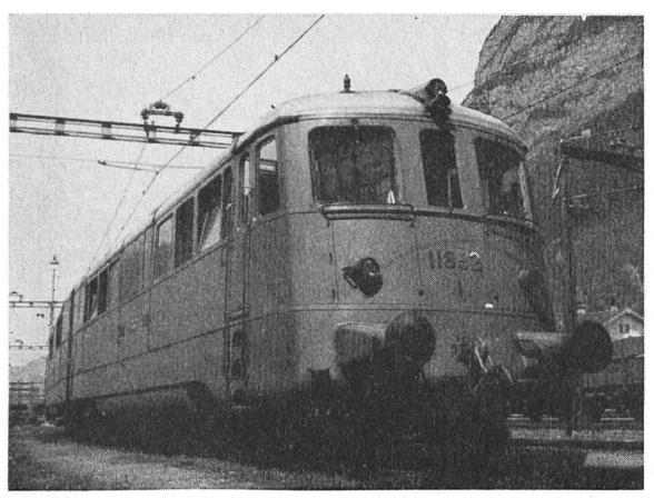
29. Stärkste elektr. Lokomotive der schweiz. Bundesbahsnen. Sie ist zugleich die stärkste der Welt und besitzt 16 Motoren mit zusammen 12000 Pferdekräften Stundenleistung. Die Höchstgeschwindigkeit beträgt 110 km in der Stunde. Über den Gotthard, wo sie jetzt verkehrt, vermag sie Züge von 770 t Gewicht mit 75 km Geschwindigkeit zu befördern.
