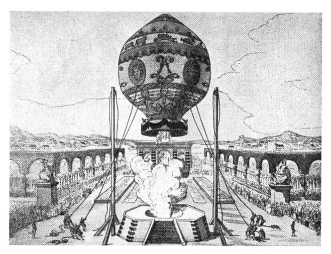
Aufstieg einer "Montgolfière" im Jahre 1783. Der Ballon wurde über einem Feuer mit warmer Luft gefüllt, bis er genügend Auftrieb hatte.
