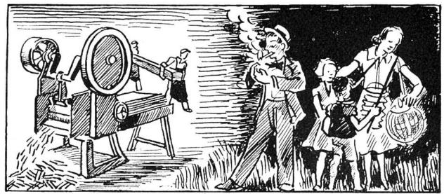
sind aus Weichholz — am besten eignet sich Espenholz — und werden mit einer dünnen Paraffinschicht überzogen. Anfertigung und Verpacken der Zündhölzer erfolgt ganz automatisch. Die Leistungsfähigkeit einer solchen Maschine reicht bis zu 10 Millionen Stück täglich.
