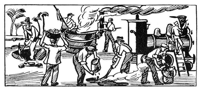
Meer gegraben. Asphaltartiges Gestein, mit Erde vermengt, findet sich auf Sizilien, in den Abruzzen und im Val de Travers (Neuenburg). Neuerdings gewinnt man Asphalt auch aus den Rückständen der Erdöl-Destillation (-Reinigung). Ausser für den Strassenbau wird Asphalt zur Herstellung von rostschützendem, schwarzem Lack, von Dachpappen und brauner Malfarbe verbraucht.
