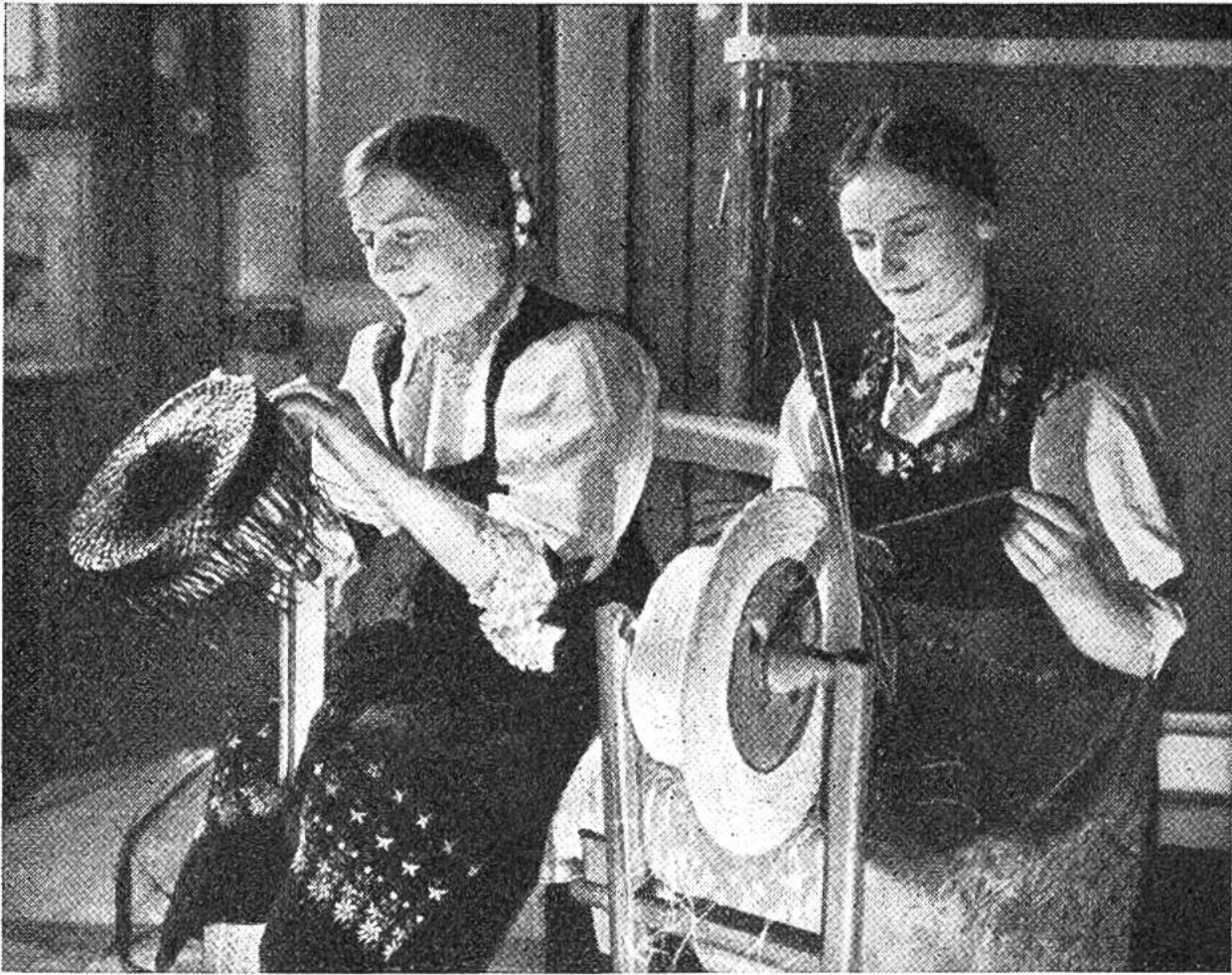
Heimarbeiterinnen in der schmucken Aargauer Tracht flechten aus Stroh Sommerhüte. Man beachte die Gestelle, die zur Anfertigung der Hüte dienen.
