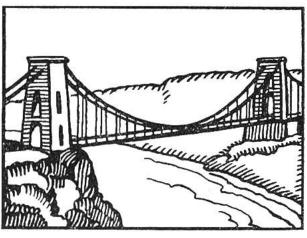
Hängebrücke. Aufhängen der Fahrbahn an Drahtseilen.
