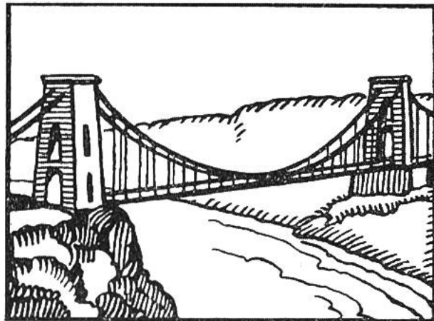
Hängebrücke. Aufhängen der Fahrbahn an Drahtseilen.
