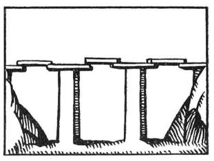
Auslegerbrücke mit Mittelpfeiler nach dem gleichen Prinzip.
