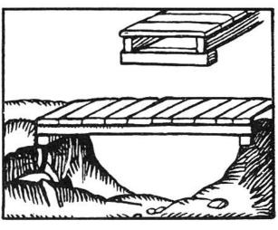
Vielsolider wird die Überbrückung, wenn zwei schmale Bretter mit der Kante gegen oben gestellt und mit kurz. Brettern verbunden werden.
