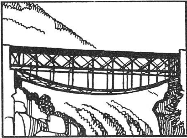
Brücke mit unter der Fahrbahn angebrachtem Balkenwerk und Bogen, das ebenfalls die Tragfähigkeit erhöht.
