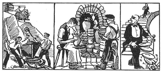
Steingut, Fayence, Majolika sind Sammelnamen für nicht durchscheinende Tonwaren, deren poröse Masse mit Glasur überzogen ist, um das Durchdringen von Flüssigkeiten zu verhindern. Die Masse besteht aus einem Gemenge von Ton und feingemahlenem Quarz und Feldspat; sie lässt sich leicht formen und bei niedriger Temperatur brennen. Nach dem Brennen und Bemalen wird eine Bleiglasur aufgebrannt. Weisses Steingut wurde zuerst in England erzeugt und ist seit 1720 ein Ersatz für Porzellan.
