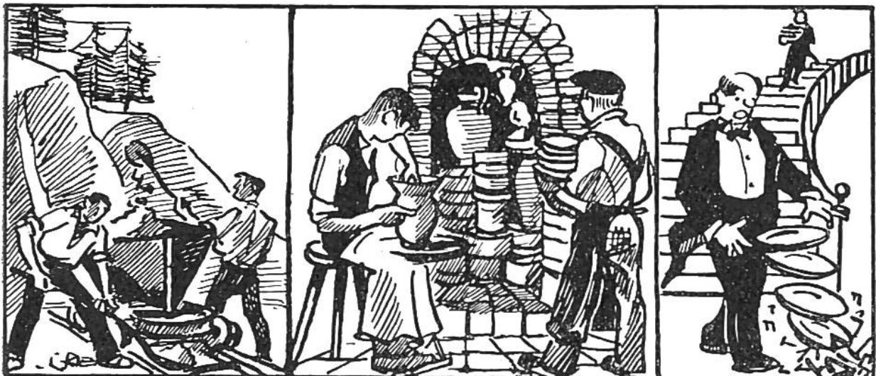
**Steingut**, Fayence, Majolika sind Sammelnamen für nicht durchscheinende Tonwaren, deren poröse Masse mit Glasur überzogen ist, um das Durchdringen von Flüssigkeiten zu verhindern. Die Masse besteht aus einem Gemenge von Ton und feingemahlenem Quarz und Feldspat; sie lässt sich leicht formen und bei niedriger Temperatur brennen. Nach dem Brennen und Bemalen wird eine Bleiglasur aufgebrannt. Weisses Steingut wurde zuerst in England erzeugt und ist seit 1720 ein Ersatz für Porzellan.
