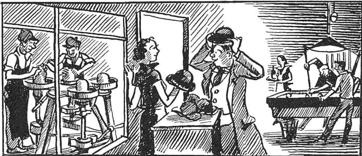
**Filz** besteht aus Schafwolle oder andern tierischen Fasern. Die Woll- oder Haarteilchen werden unter Einwirkung von Seife und anderen Stoffen sowie heissen Dämpfen zu einer zusammenhängenden Schicht vereinigt und diese durch Pressen zwischen Walzen gefestigt. Schon die alten Griechen kannten die Technik des Filzens. Hauptsächlichste Verwendung: für Filzhüte und Filzschuhe sowie für Wärme-Isoliermittel und Filztücher (auf Billardtische).
