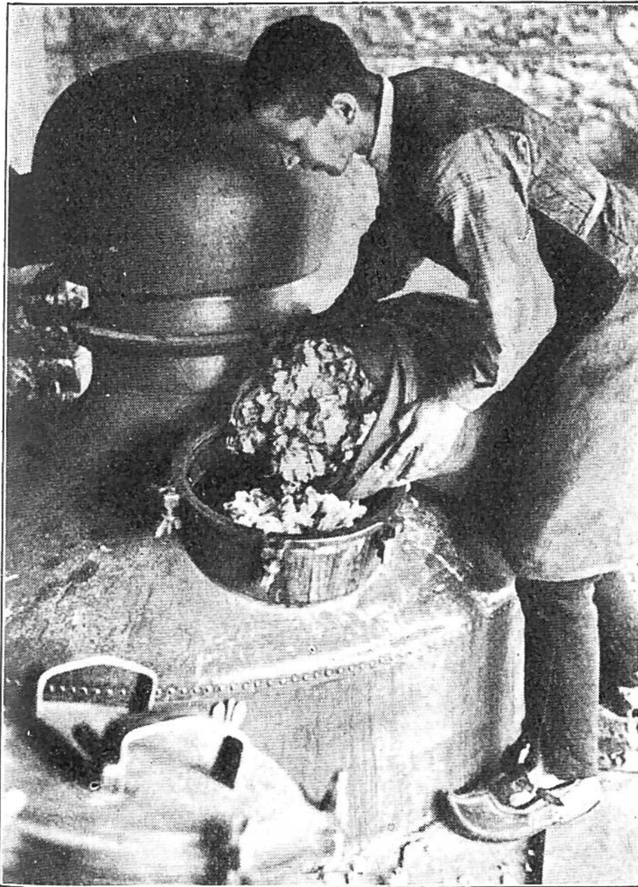
Bulgarischer Bauer schüttet Rosen in den Verdampfungskessel; hier werden sie mit Wasser gekocht, wobei das Rosenöl, ein im Handel beehrter Riechstoff, gewonnen wird.
