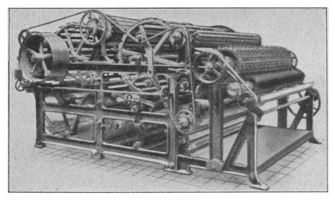
Rauhmaschine aus einer Weberei. Die dicke Walze rechts ist über und über mit kratzenden Kardenköpfen bedeckt.
