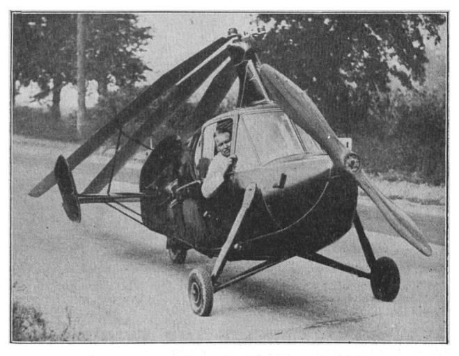
Das "Autogiro" ist eine Verbindung von Automobil und Flugzeug. Hat der metallene Riesenvogel nach seiner Fahrt durch die Lüfte den Erdboden erreicht, so lassen sich seine Schwingen zusammenklappen: das Flugzeug ist zum Automobil geworden.
