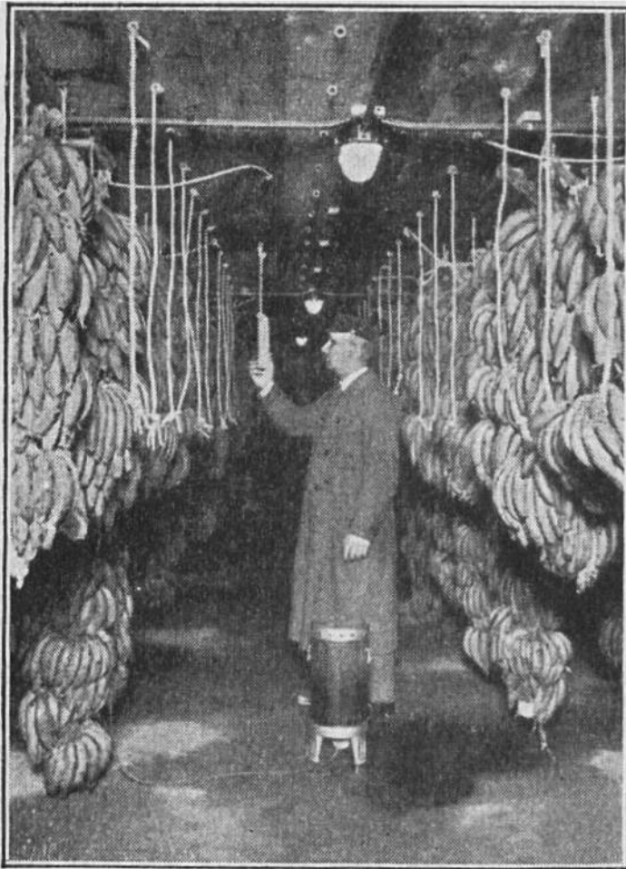
Der Reiferaum in einem riesigen europäischen Lagerhaus für Bananen. Hierhin werden, je nach Bedarf, die bald zum Verkauf gelangenden Bananen gebracht. Sie reifen da in tropischer Temperatur und Luftfeuchtigkeit bis zu dem gewünschten Grade.
