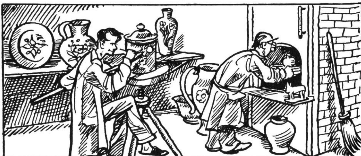
**Glasur und Email** sind glasartige Massen, die auf Ton- und Metallwaren durch Aufschmelzen angebracht werden. Sie bestehen wie Glas aus Kieselsäure, enthalten aber je nach ihrem Zweck die verschiedensten Zusätze (Erden, Metalle, Salze). Der Glasur- oder Emailbrei wird oft gefärbt. Häufig kommen Verzierungen oder Malereien unter oder über die Glasur- oder Emailschicht.
