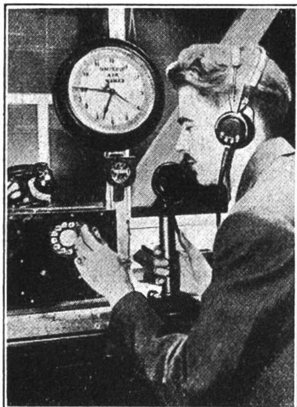
Mit Hilfe des Radiophons kann der Wetterwart mit jedem entsprechend ausgerüsteten Flugzeug während seines Fluges telephonieren.
