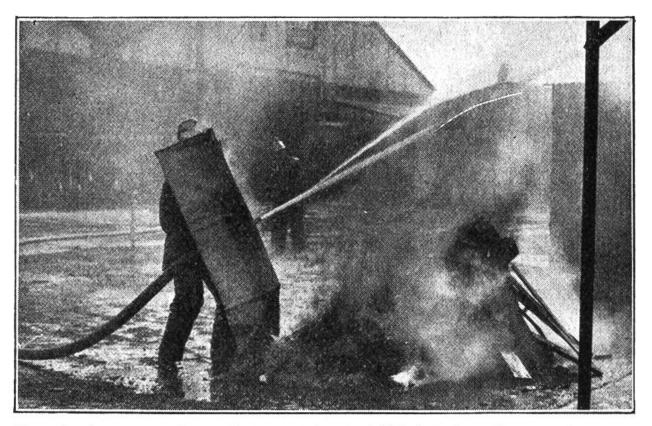
Durch den unverbrennlichen Asbestschild ist der Feuerwehrmann vor Flammen und Hitze geschützt. Das Messingmundstück des Schlauches wird durch eine kleine Öffnung des Schildes gesteckt.
