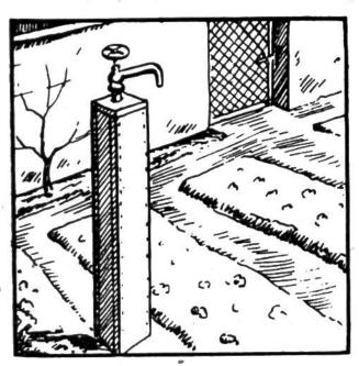
Um die Röhre herum wird ein primitiver Holzkasten aus vier schmalen Brettchen angebracht. Den Hohlraum zwischen Röhre und Kasten füllt man zur bessern Befestigung und Isolierung mit Sand oder Sägespänen. Die obere Öffnung um den Wasserhahn wird mit einem passenden Brettchen verschlossen. Wer das Ganze besonders hübsch ausführen will, bemalt den Kasten.
