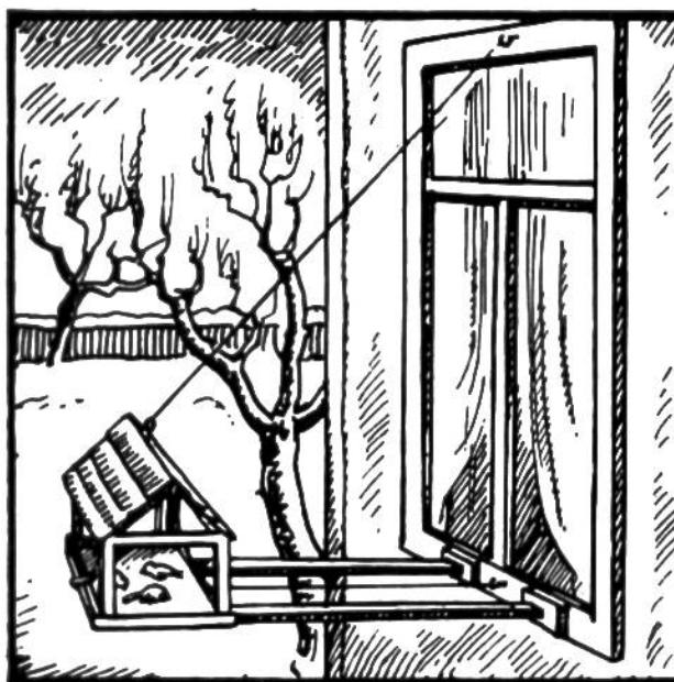
Zwei Holzstäbe von derselben Länge werden am Boden des Futterhäuschens festgemacht. Die beiden Stabenden stecken in zwei entsprechenden Fassungen am Fensterrahmen. Ein Draht, am Dach des Häuschens befestigt und oben im Fensterrahmen verankert, hält das Häuschen in der Waagrechte. Ein weiterer Draht, zwischen den 2 Stäben angebracht, schützt das Häuschen vor d. Aushängen.
