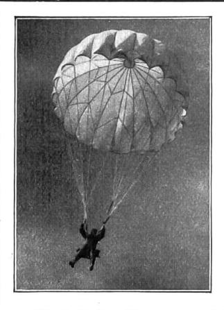
Hier sieht man deutlich, wie der Springer im Traggurt hängt, der durch die Fangleinen mit der Fallschirmhülle verbunden ist. Durch Ziehen der Leinen hat der Fallschirmabspringer eine beschränkte Lenkmöglichkeit.
