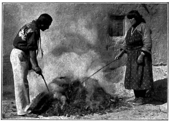
Zum Brennen des irdenen Geschirrs brauchen die Pueblo-Indianer keinen Brennofen. Die Töpfe werden in einen glühend heissen Aschenhaufen eingegraben. Nach einigen Stunden sind sie hartgebrannt und können hervorgeholt werden.
