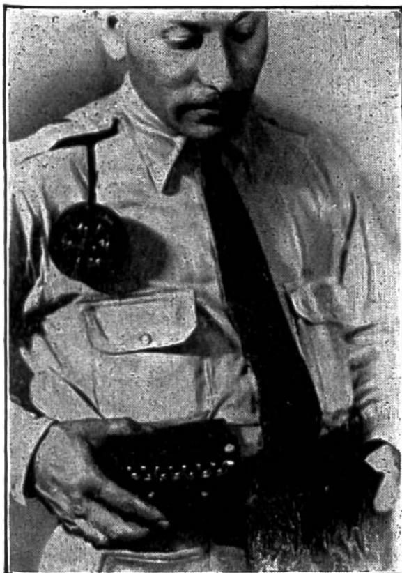
Batterie werden am Leibgurt des Polizisten befestigt, der Lautsprecher an seiner Schulter. Als Antenne dient der Körper des Trägers. Das Gerät, das nicht schwerer als eine Dienstpistole sein soll, ist auf den Polizeisender abgestimmt, so dass einem diensttuenden Mann jederzeit wichtige Nachrichten übermittelt werden können.
